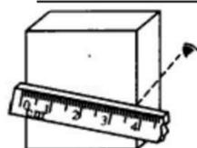
23. 沈思彤同学用分度值为1mm的刻度尺测量一个物体的长度, 四次测量的数值分别为2.35cm、2.56cm、2.36cm、2.36cm, 则测量结果应记为 \_\_\_\_\_ cm, 多次测量的目的是 \_\_\_\_\_。
