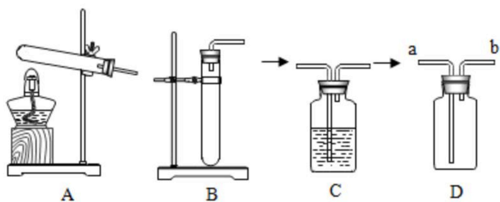
①实验室用 $H_2O_2$ 制取氧气的化学方程式为 \_\_\_\_\_，可选择的发生装置为 \_\_\_\_\_（填字母）。
