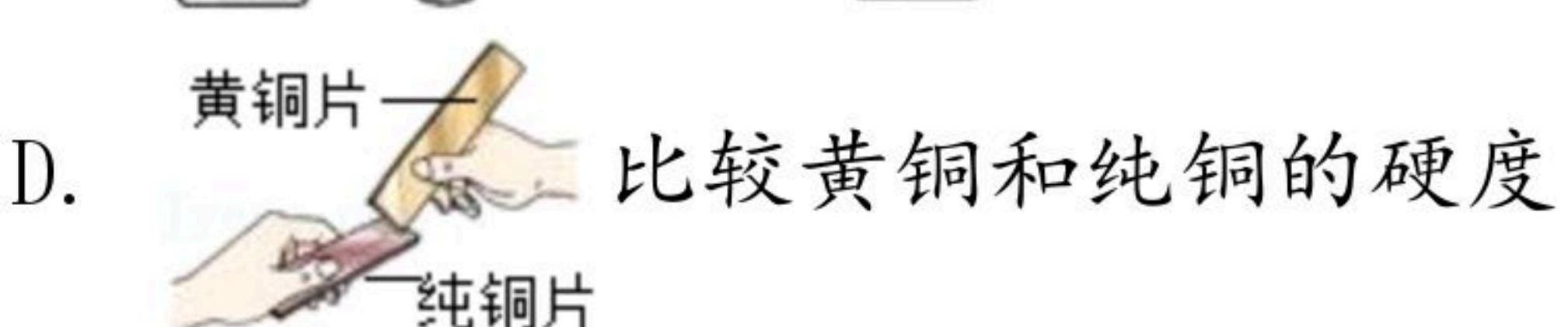
比较黄铜和纯铜的硬度
