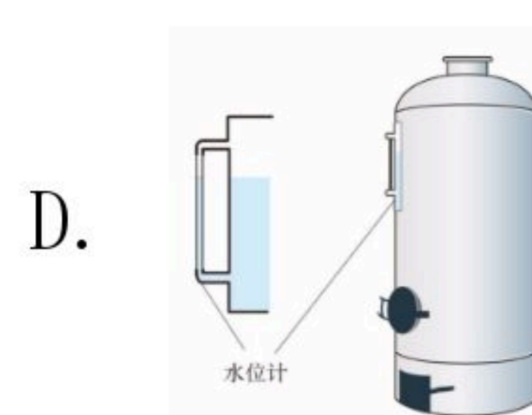
锅炉外面安装水位计
