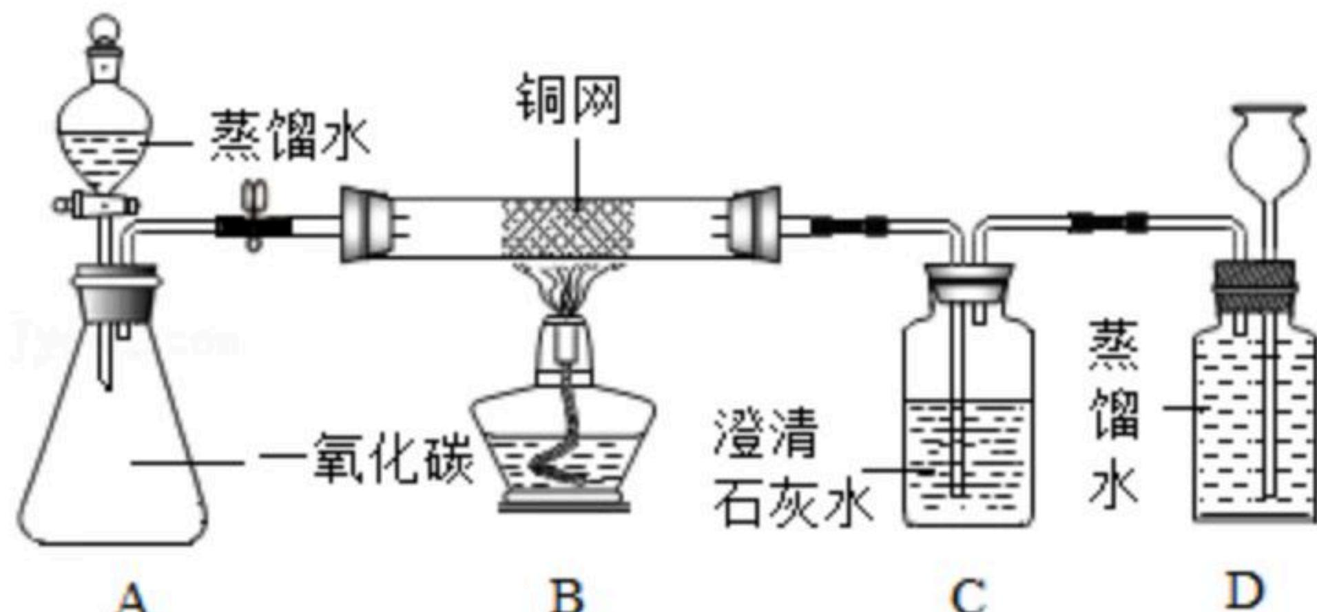
(1) 关闭弹簧夹K，点燃酒精灯，铜网与装置内的氧气反应生成氧化铜，该反应的化学方程式是 \_\_\_\_\_。
