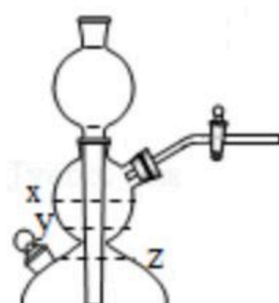
(1) 实验室常用块状大理石与稀盐酸制备二氧化碳，该反应的化学方程式是 \_\_\_\_\_。选用如图装置作为发生装置，待气体收集满后关闭活塞，装置内液面将由x降至 \_\_\_\_\_ 处（选填“y”或“z”），此时装置内气体压强 \_\_\_\_\_ 外界大气压（选填“大于”、“等于”或“小于”）。
