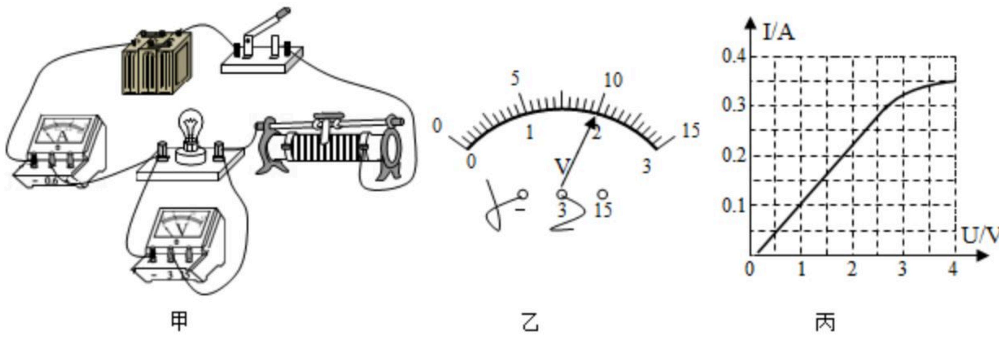
(1) 小明同学闭合开关，移动滑动变阻器的滑片到某点，电压表的示数如图乙所示，若他想测量小灯泡的额定功率，应将图甲中的滑片向\_\_\_\_\_（选填“左”或“右”）端移动，使电压表示数为2.5V。
