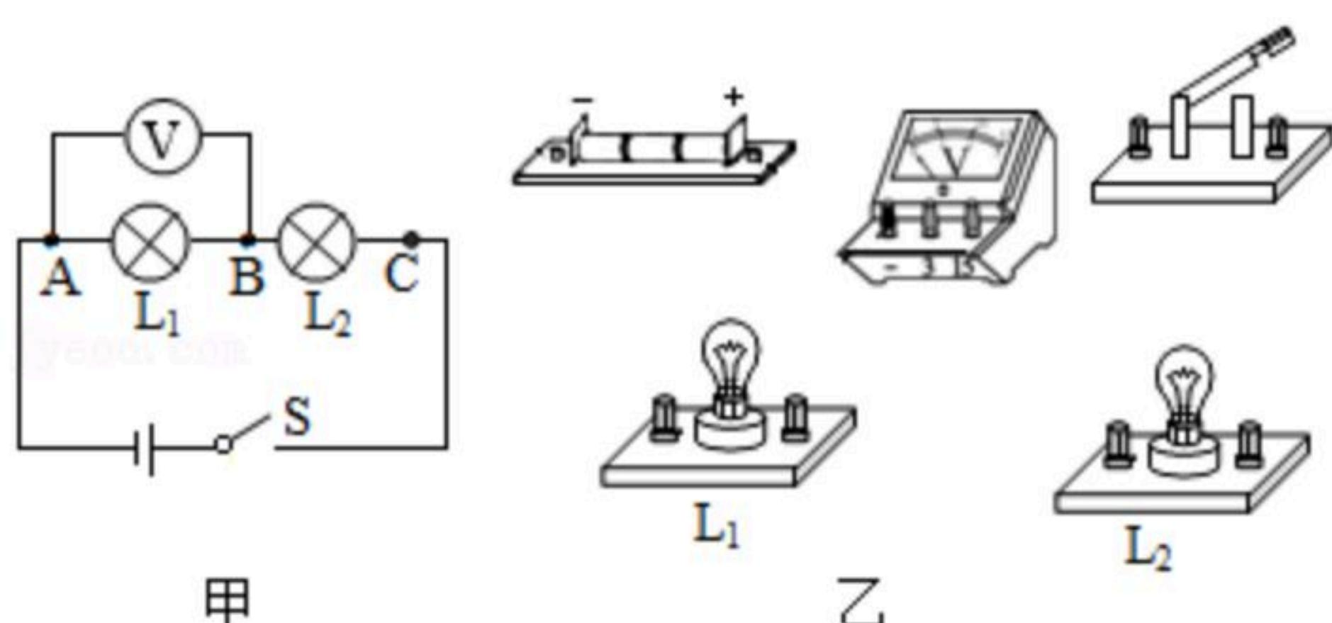
(1) 根据电路图甲，用连线代替导线连接实物电路图乙。
