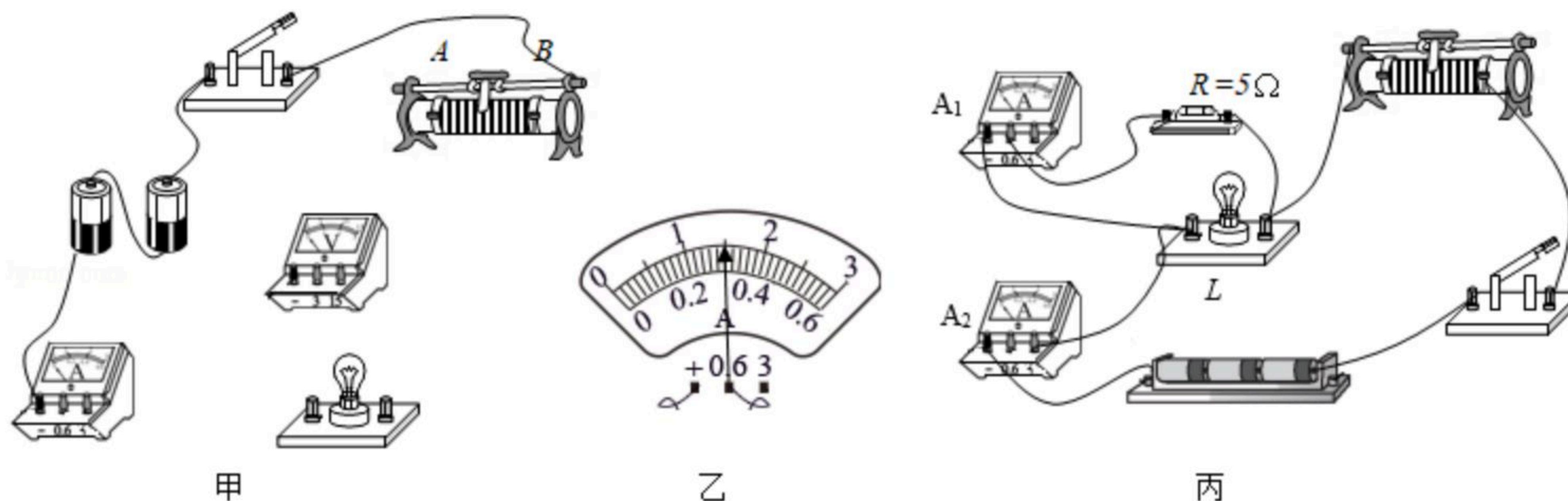
(1) 请用笔画线代替导线将甲图的实验电路中未连接部分补充完整。（要求：闭合开关前，将滑动变阻器的滑片置于A端）
