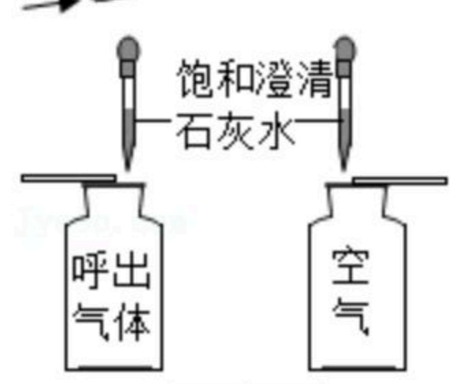
实验能够说明呼出气体中的 $CO_2$ 含量比空气中的大
