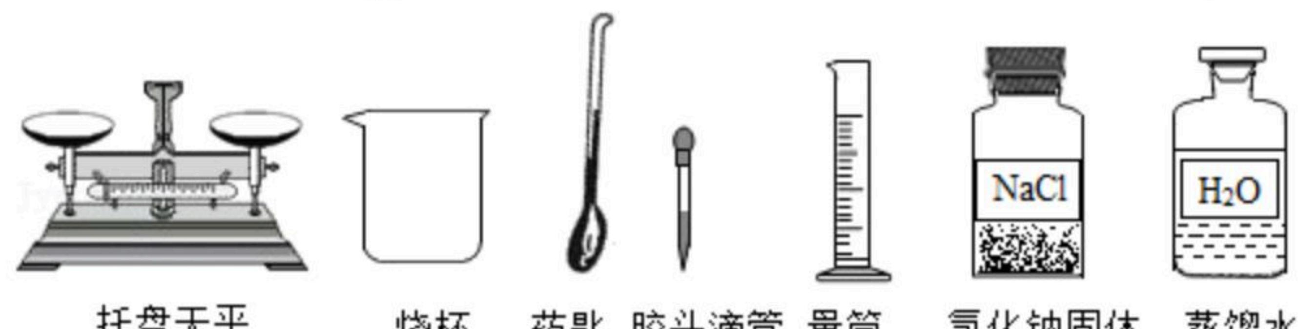
托盘天平      烧杯      药匙      胶头滴管      量筒      氯化钠固体      蒸馏水
