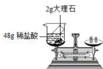
按如图方式放好仪器和药品，使天平平衡，记录称量数据。然后将小试管内的稀盐酸倒
