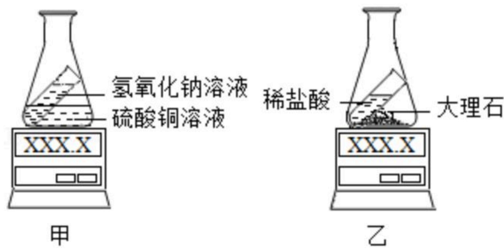
【实验步骤】①称量反应前锥形瓶的总质量，记录天平示数。
