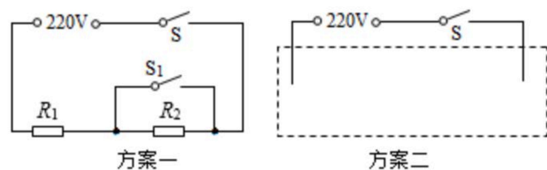
(2) 【器材选择】若该壶是按照方案一设计的，根据项目任务中的性能要求，选择的加热电阻阻值最大为多少欧姆？ $[Q_{吸}=cm(t-t_0), c_{水}=4.2\times 10^3 J/(kg\cdot ^\circ C)]$
