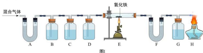
(1) 装置A中无水硫酸铜由白色变为蓝色，装置B中澄清石灰水变浑浊，由此得出的结论为混合气体中有\_\_\_\_\_。B中发生反应的化学方程式为\_\_\_\_\_。
