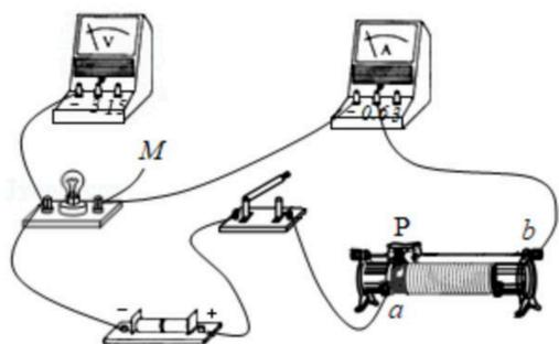
(1) 连接如图所示电路时, 导线M的另一端已经接在电压表 \_\_\_\_\_ V (选填“3”或“15”) 接线柱上。
