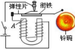
直流电铃原理图，电流通过的电磁铁时，它的A端为S极
