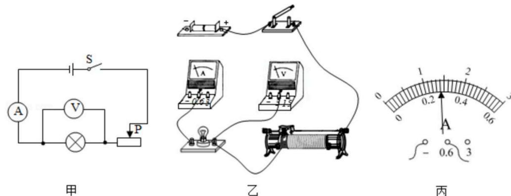
(1) 请你用笔画线代替导线，把乙图中的实物图电路连接完整。
