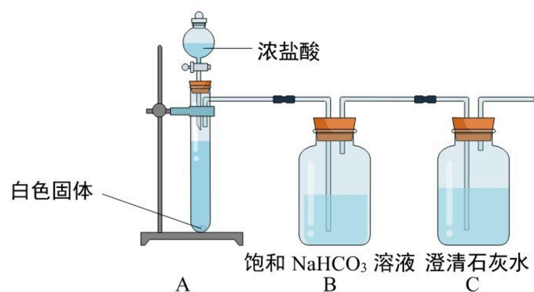
(7) 【实验现象】A中有大量气泡产生，C中实验现象是\_\_\_\_\_。
