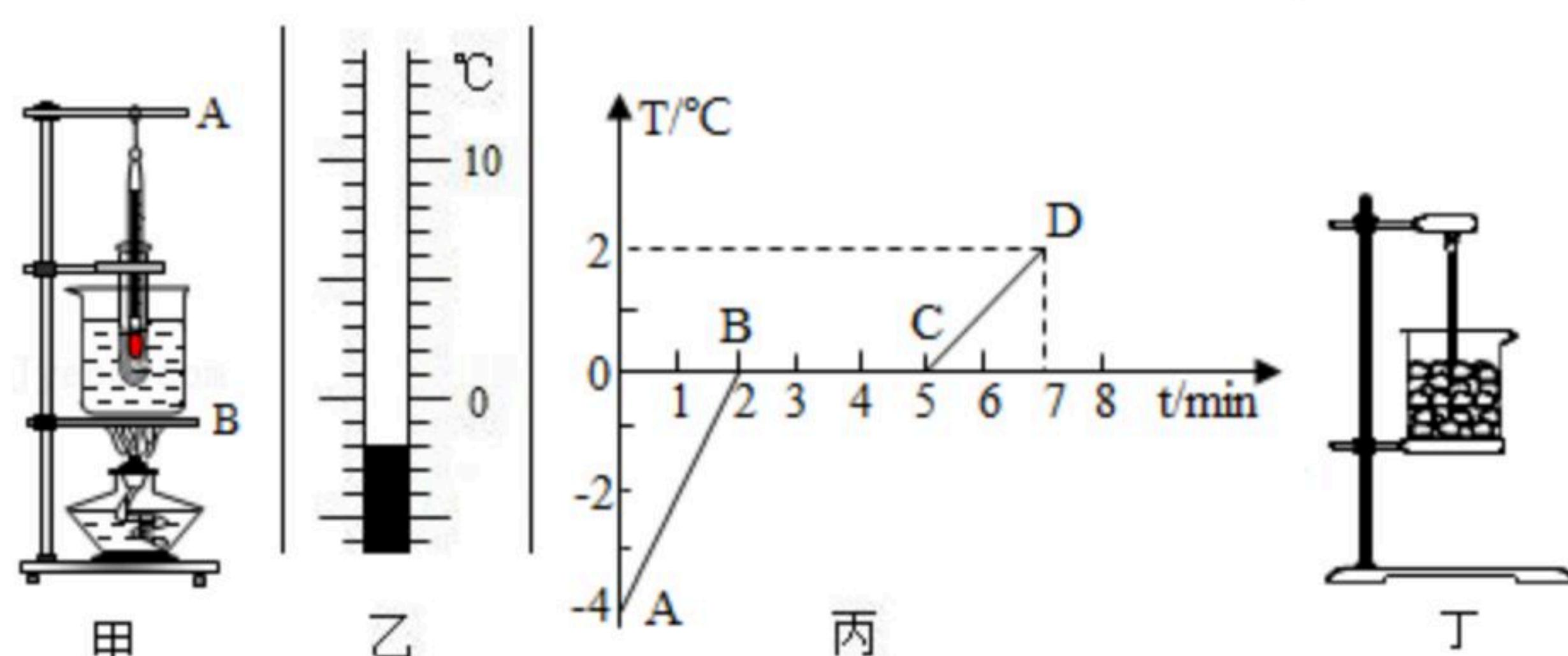
(1) 实验时应将 \_\_\_\_\_ (选填“整块冰”或“碎冰”) 放入图甲装置试管中，将试管放入装有热水的烧杯中加热的优点是 \_\_\_\_\_，而且冰的温度升高较 \_\_\_\_\_ (选填“快”或“慢”)，便于记录各个时刻的温度，同时观察试管中冰的状态变化。
