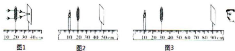
(1) 如图所示, 让平行光正对着凸透镜照射, 左右移动光屏, 直到光屏上出现一个最小最亮的光斑, 测得凸透镜的焦距 $f=$ \_\_\_\_\_cm。
